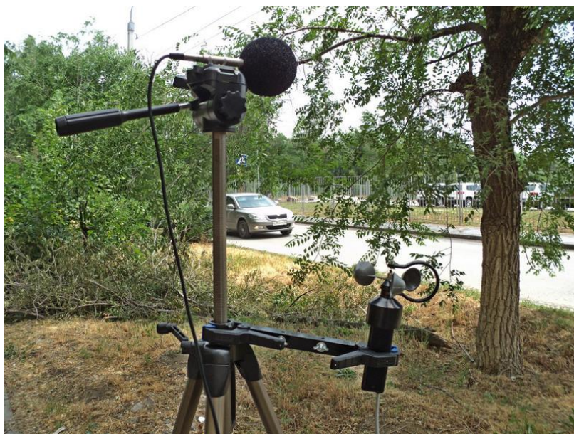
Процесс измерения уровня шума от автомобильной дороги рядом с жилой застройкой
