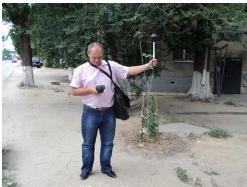
Измерение уровня электромагнитного поля на ул. Шекснинская от ЛЭП.
